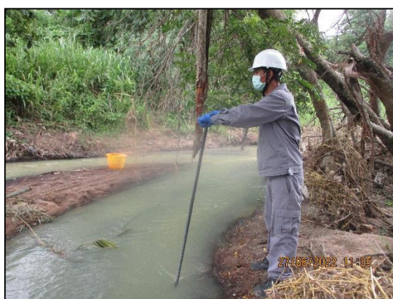
รูปที่ 3.33 การเก็บตัวอย่างโลหะหนักในตะกอนดินบริเวณคลองดอกทราย (SD6)
