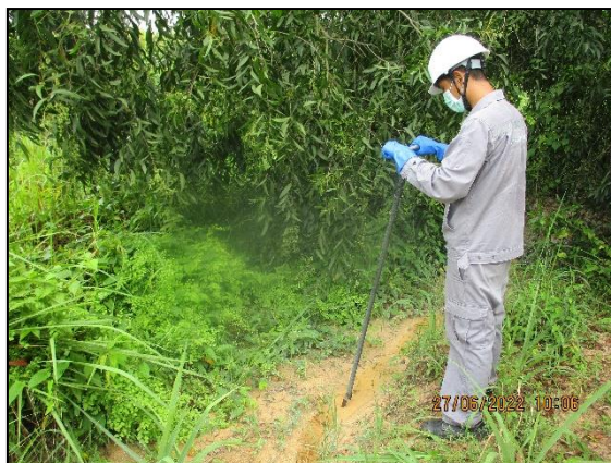
รูปที่ 3.29 การเก็บตัวอย่างโลหะหนักในตะกอนดิน บริเวณคลองควายชุดบ่อจุดระบายน้ำทิ้งของโครงการ (SD2)
