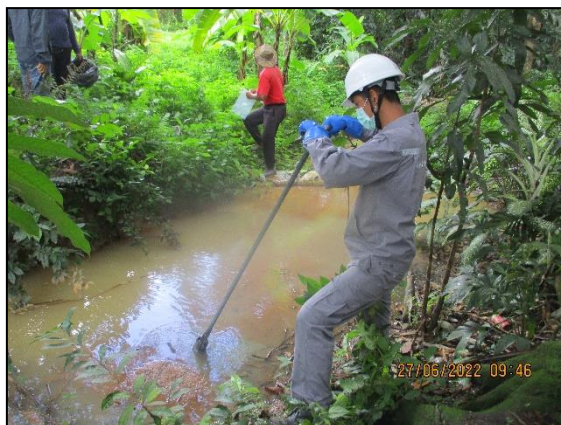
รูปที่ 3.30 การเก็บตัวอย่างโลหะหนักในตะกอนดิน บริเวณคลองควายชุดหลังบ่อจุดระบายน้ำทิ้ง 500 เมตร (SD3)
