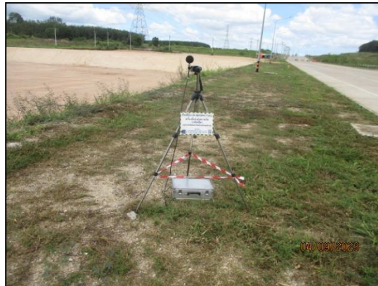
รูปที่ 3.8 ตรวจวัดระดับเสียง 15 นาที บริเวณ เครื่องจักร/เครื่องมือ ซึ่งเป็นแหล่งกำเนิดเสียงในการก่อสร้าง (N4)
