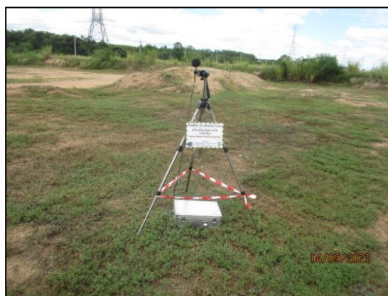
รูปที่ 3.7 การตรวจวัดระดับเสียง 15 นาที บริเวณเครื่องจักร/เครื่องมือ ซึ่งเป็นแหล่งกำเนิดเสียงในการก่อสร้าง (N3)
