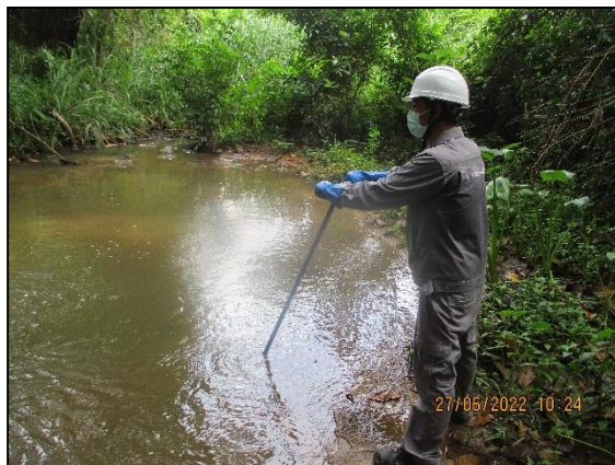
รูปที่ 3.31 การเก็บตัวอย่างโลหะหนักในตะกอนดิน บริเวณคลองควายชุดบ่อหลังบรรจบคลองสาธารณะประโยชน์ (SD4)
