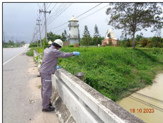
รูปที่ 3.16 การเก็บตัวอย่างคุณภาพน้ำผิวดิน บริเวณคลองดอกกรายหลังบรรจบคลองควายชุดบ่อ (SW5)
