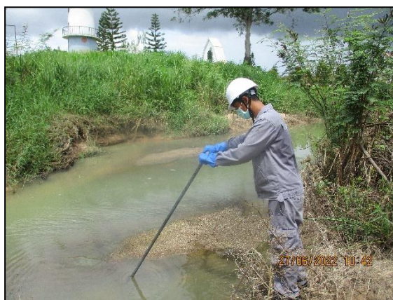
รูปที่ 3.32 การเก็บตัวอย่างโลหะหนักในตะกอนดิน บริเวณคลองดอกทรายหลังบรรจบคลองควายชุด (SD5)
